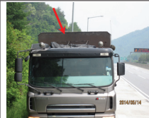
〈전면 보조틀 설치〉
