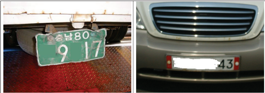
〈번호판 봉인 탈락〉
