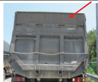
〈후면 보조틀 설치〉
